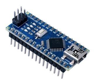
Arduino NANO - компактная платформа для прототипирования микроэлектронных устройств, предназначенная для использования с макетной платой. Функционал устройства во многом схож с Arduino UNO и отличается от нее лишь размерами платы и отсутствием отдельного разъема для питания.
