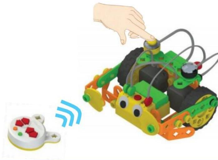
6 Нажмите на контактный датчик робота, чтобы робот начал работать. Теперь вы можете управлять роботом дистанционно!
