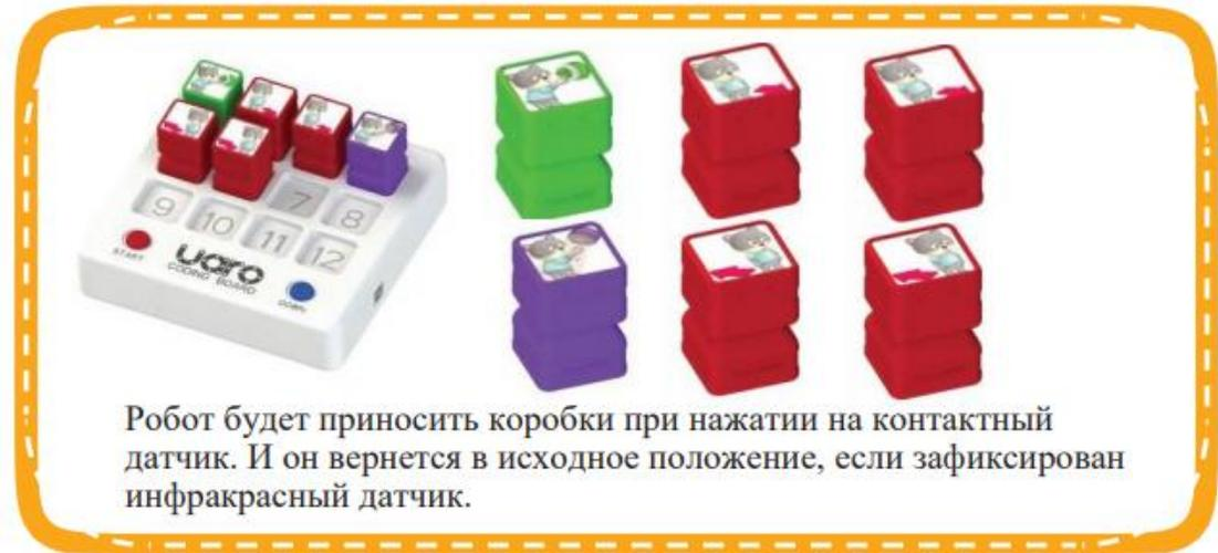
Робот будет приносить коробки при нажатии на контактный датчик. И он вернется в исходное положение, если зафиксирован инфракрасный датчик.
